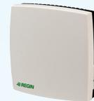
Liten påvegg mekanisk romhygrostat for fuktstyring av vifter. Maks 1,5A. Innstilling 10-90%RF.
